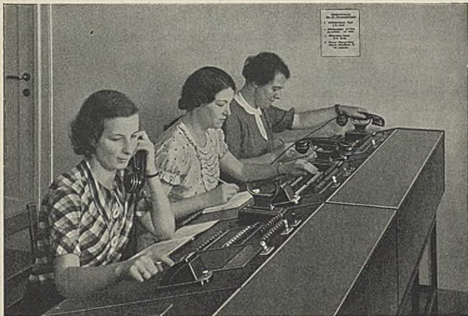
Vermittlungsplätze einer großen Nebenstellenanlage.
