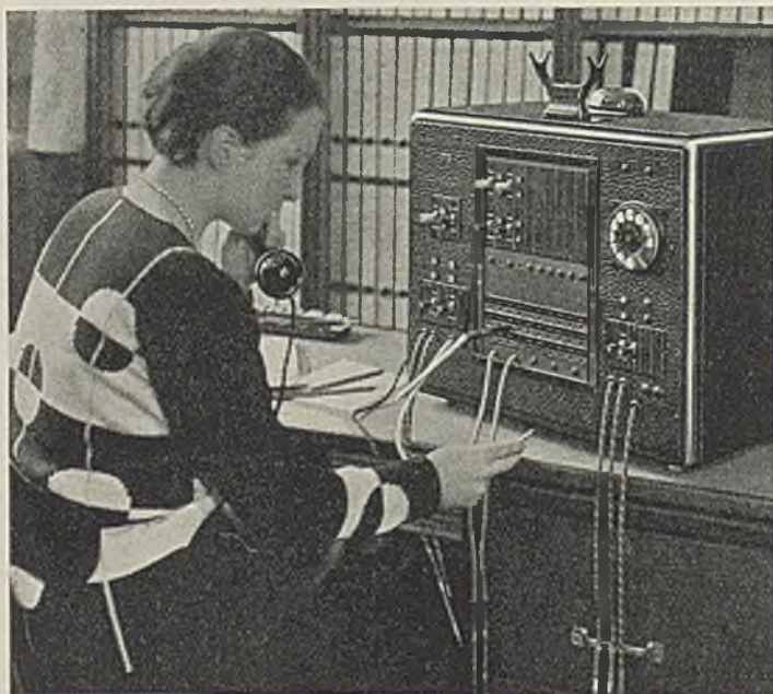
Schauzeichenschrank für handbedienten Amts- und Hausverkehr, ausbaufähig bis 5 Amtsleitungen und 50 Sprechstellen.
