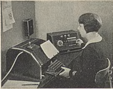
Fernschreib-Kleinzentrale für 5 Anschlüsse.
