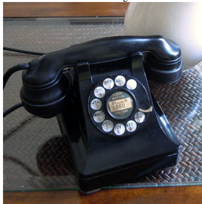
Téléphone Western Electric 302 de 1948 qui a été remis à neuf au milieu des pénuries d'équipement d'après-guerre avec un combiné de style plus ancien (E1) et installé sur une ligne du central de Newark, NJ, « Bigelow », le dernier bureau du panneau existant lorsqu'il a été démantelé en 1983.
