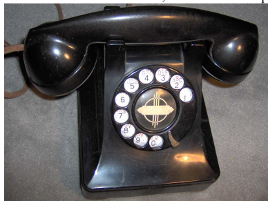
Téléphone et une radio fédéraux de type 803 de 1945, un clone du 302 utilisant des composants électriques automatiques pour des applications militaires.
