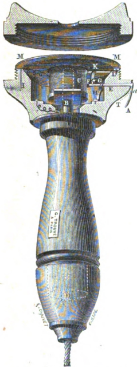
FIG. 229. — Téléphone avertisseur du capitaine Perrodon, modifié et construit par M. Gustave Trouvé.
