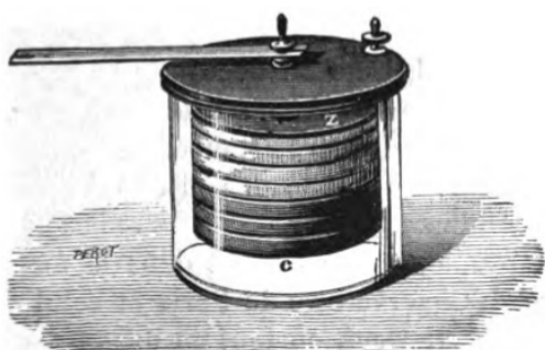
FIG 32 — Pile humide enfermée dans un vase de verre, système de M.Gustave Trouvé.
