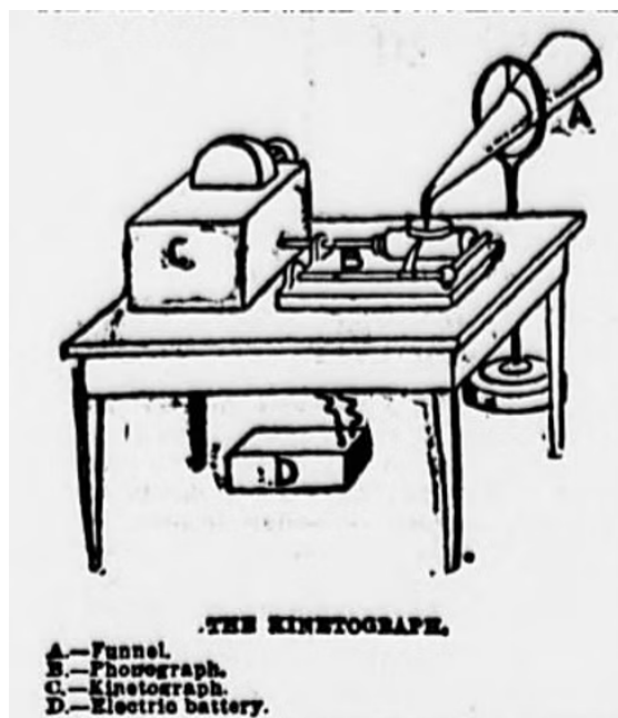
Le kinetograph. Schéma paru dans The Sun , 28 mai 1891.
