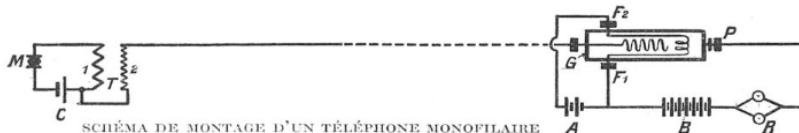
SCHEMA DE MONTAGE D'UN TELEPHONE MONIFILAIRE
