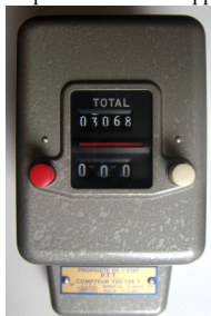
Compteur de taxes téléphoniques installé chez l'abonné
