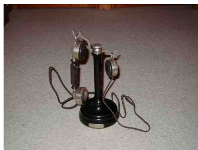
Téléphone à batterie centrale combiné au système de signalisation d'hôtel.
