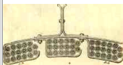
Plafonnier de 3 fois 17 câbles
