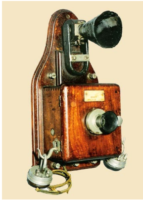
Modèle type avec des récepteurs Ader et un émetteur de Hunnings.
