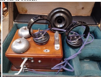
Le téléphone est un poste Edison avec deux écouteurs. Le micro se place dans son encoche sur le boîtier.
