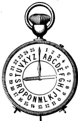
FIG. 223. — Montre télégraphique militaire, en grandeur naturelle, avec manipulateur et récepteur. Disposition de M. Gustave Trouvé.
