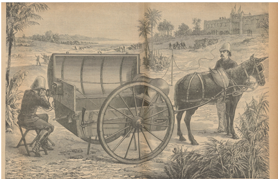
Le téléphone est un poste Edison avec deux écouteurs. Le micro se place dans son encoche sur le boîtier.
