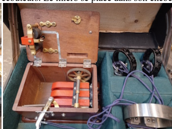
Le téléphone est un poste Edison avec deux écouteurs. Le micro se place dans son encoche sur le boîtier.
