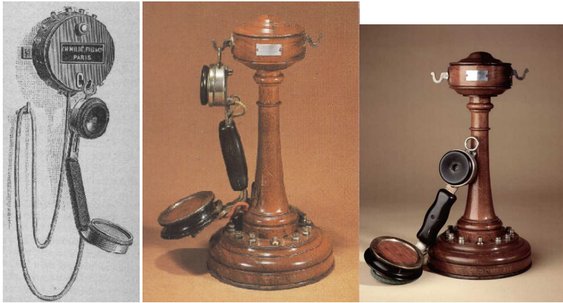
Transmetteur microphonique Steiner combiné avec applique vers 1894 (Microphone à grenaille)
