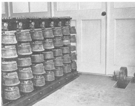
Le commutateur Unité de commutation de 100 lignes avec sept divisions de connexion
