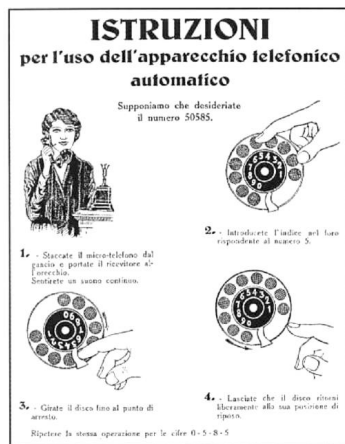
Instructions pour l'utilisation des téléphones automatiques (vers 1923)
