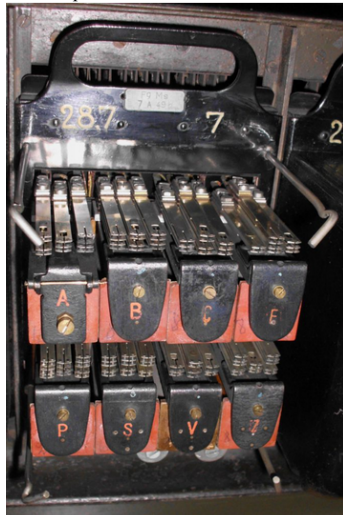
L'image montre en gros plan un segment multiple avec un bras de commutation a/b connecté.
