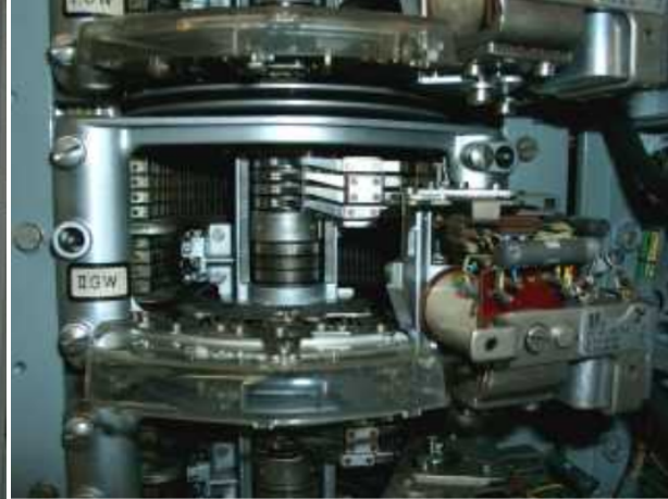
Fig. 8. Bürstenwagen des EMD-Wählers Porte-balais d'un sélecteur à contacts en métal rare
