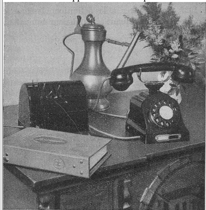
Fig. 8. — Poste d'abonné avec déviateur d'appels.
