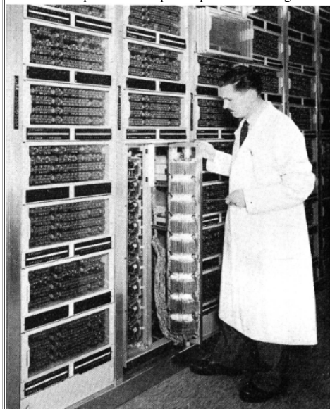
Fig. 3. Châssis de relais et cadre de viseur pivotant de 30 mm
