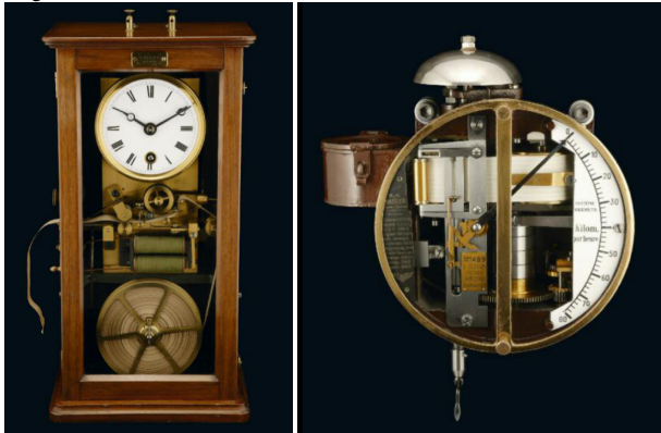
Horloge de contrôle pour l'enregistrement de la vitesse des trains depuis la gare, vers 1870 et Compteur de vitesse pour locomotives, système Hausshälter, vers 1889.
