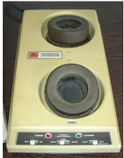
C'est un modem acoustique, sur lequel repose le combiné d'un téléphone.
