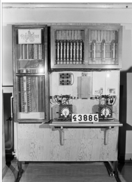
.Photo des sélecteurs de montée Betulander, année 1900. Stand de Hultman avec registre et inverseur de série pour 2000 abonnés. (regardez les cadrans
