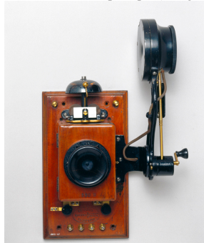
Figure 9 : Téléphone mural avec récepteur à craie Edison
