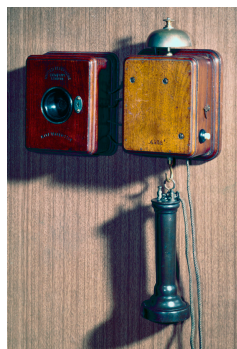
Figure 7 : Téléphone mural utilisant un émetteur Blake
