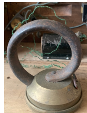
Fig. 58. — Premier microphone D'ARSONVAL-PAUL BERT, à crayons de charbon trempant dans un godet de mercure.
