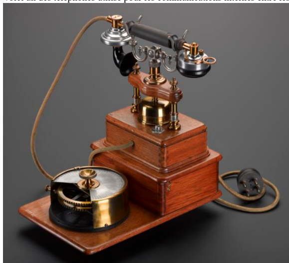
Appareil de table à cadran, fabriqué par la Clark Automatic Telephone Company, États-Unis, 1903, le cadran est coupé pour voir l'intérieur. Tiré du standard téléphonique automatique interservices installé à l'hôpital Guy's, février 1903.
