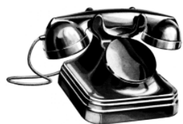
Poste téléphonique mobile à batterie centrale.
