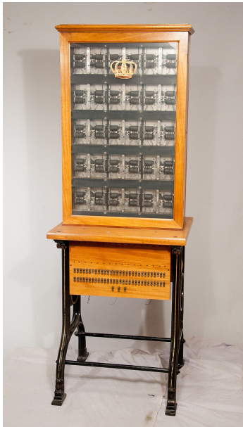
Centre téléphonique automatique de la construction de Betulander , exposé à Paris 1900 , puis utilisé à Järfa, Nacka., L'ancêtre du cadran posé à coté du téléphone
