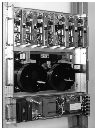
Photo d'une Machine Parlante équipant un Commutateur téléphonique Crossbar CP400 .
