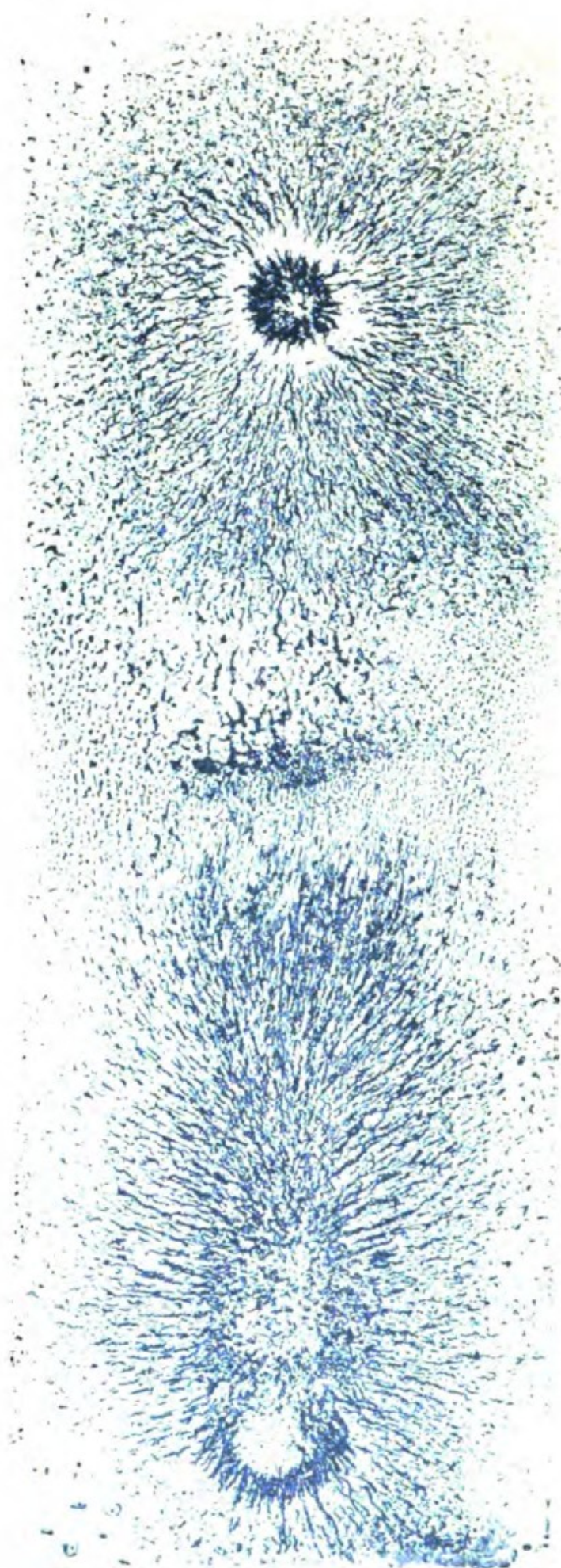
Fig. 25. — Fantôme du récepteur Bréguet.
