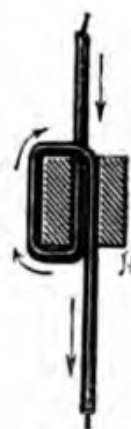
Fig. 282. — Passage du fil dans les isolateurs.
