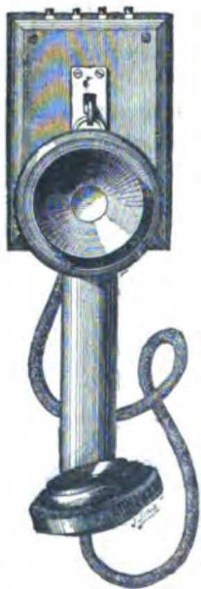
Fig. 127. — Transmetteur Deckert, modèle réduit.
