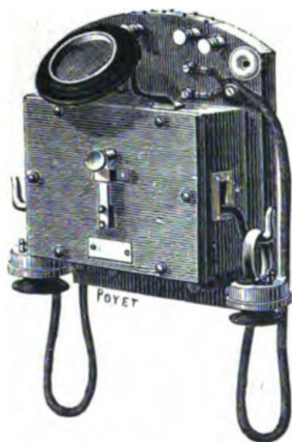
Fig. 101. — Transmetteur Berthon, type n° 2.
