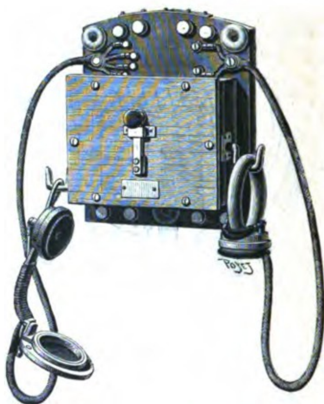
Fig. 110. — Transmetteur Berthon, type n° 9.
