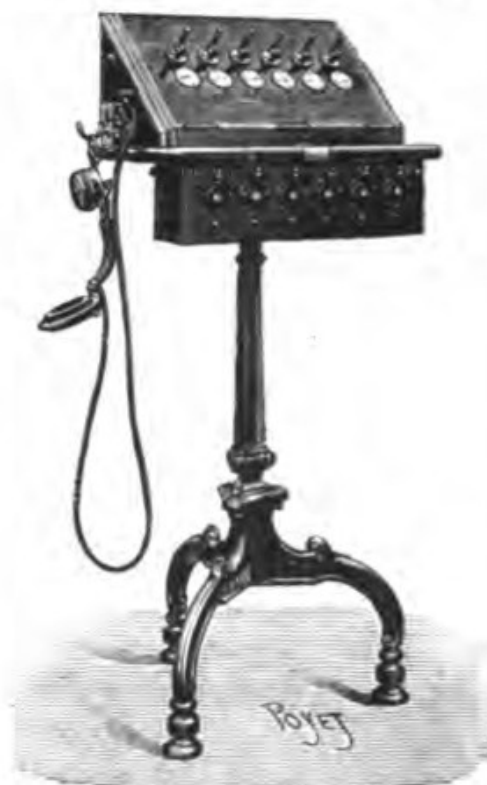
Fig. 263. — Tableau à leviers-commutateurs, modèle à pied.
