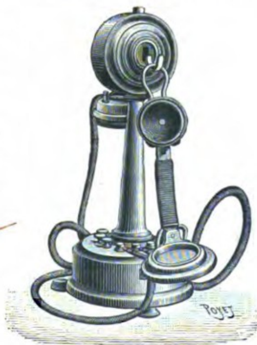
Fig. 109. — Transmetteur Berthou, type n° 10.
