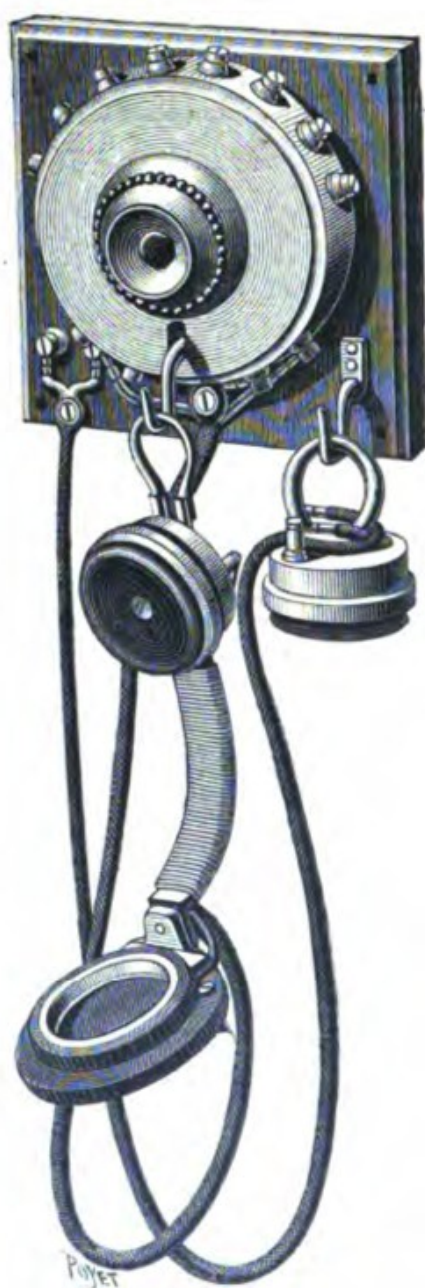
Fig. 107. — Transmetteur Berthon, type n° 8 bis.
