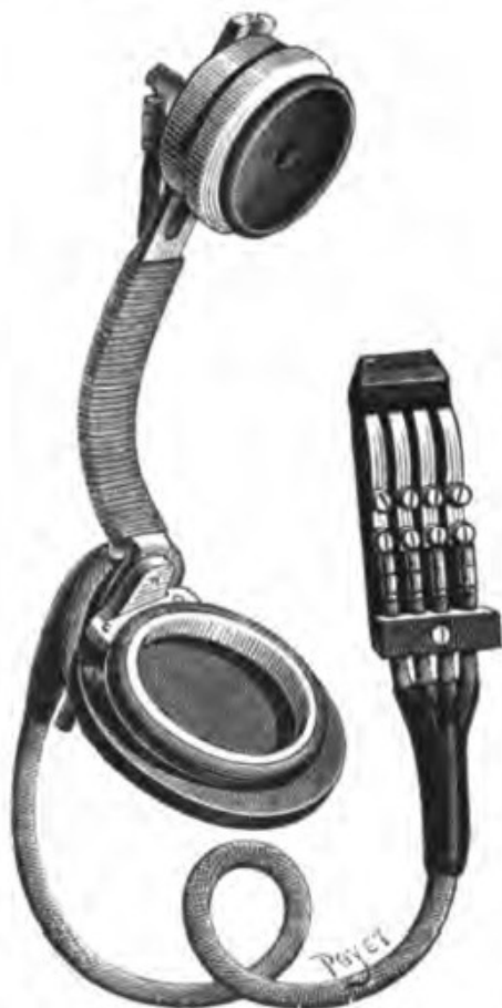
Fig. 359. — Appareil d'opérateur Berthon-Ader.
