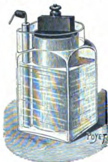
Fig. 69. — Pile Leclanché à vase poreux.
